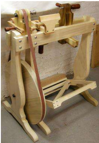
Элемент конечного продукта ТП (кривошипный механизм с маховиком)
